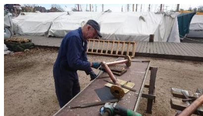
Ted Nilsen pusser kjølevannsrør
