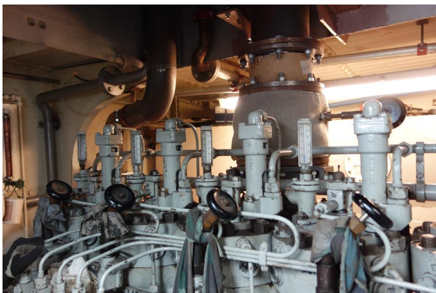
Temperaturmålere for kjølevann på sylindrene
