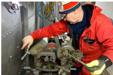
Arild Hansen lager koninger for rørforbindelser.
