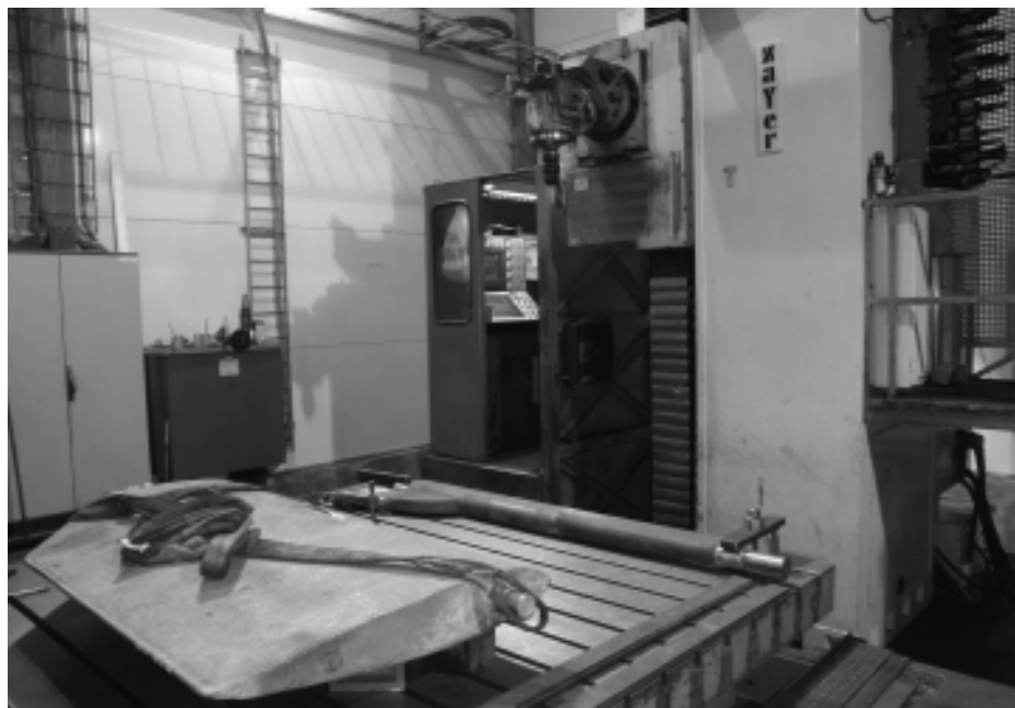
Ror og rorstamme er spent opp i bor- og freseverket for bearbeiding. Fresehodet sees øverst midt på bildet. Som man ser er det store dimensjoner på maskinen. Foto: Ole Henrik Torp
